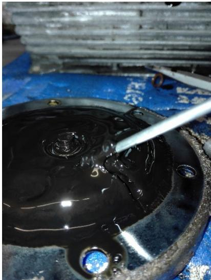
Bei einem Käfer Motor gibt es auch höhere Toleranzen, als bei modernen Motoren. Würde man ein modernes Motoröl in einen Käfer Motor kippen, würde der Motor das mit Undichtigkeiten beantworten. Außerdem halten moderne Öle die Schmutzteilchen im Öl in Schwebe, moderne Motoren filtern diese dann mit einem Ölfilter aus dem System. Das alles hat der normale Käfer nicht.
